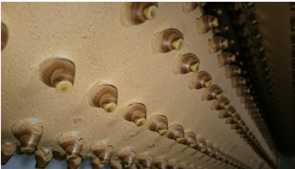
Accumulation de colle sur les picots des rouleaux de conformatrice
