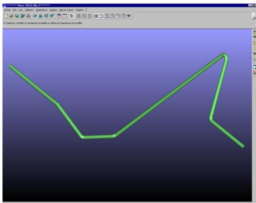
*Pièce de présence cuve dans une friteuse, modélisée en 3D après développement*
